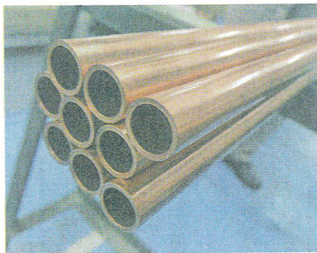
国際核融合実験炉(ITER)の重要機器で用いられる銅・クロム・ジルコニウム合金管
