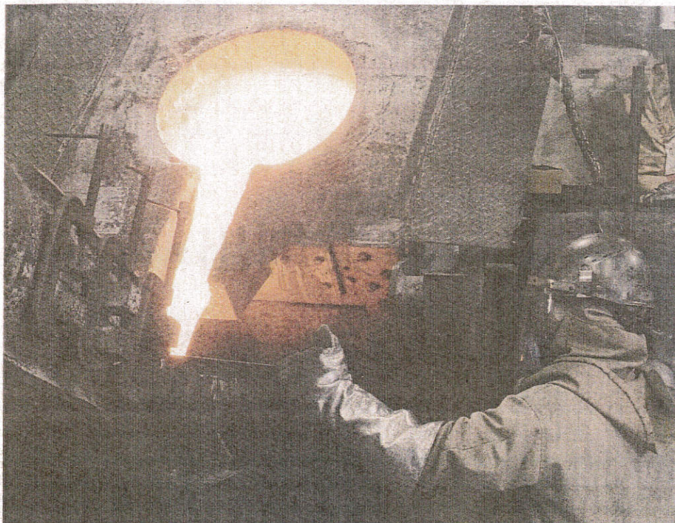
溶解炉を斜めに傾け、熱く溶けた銅合金を鑄型に注ぎ込む
