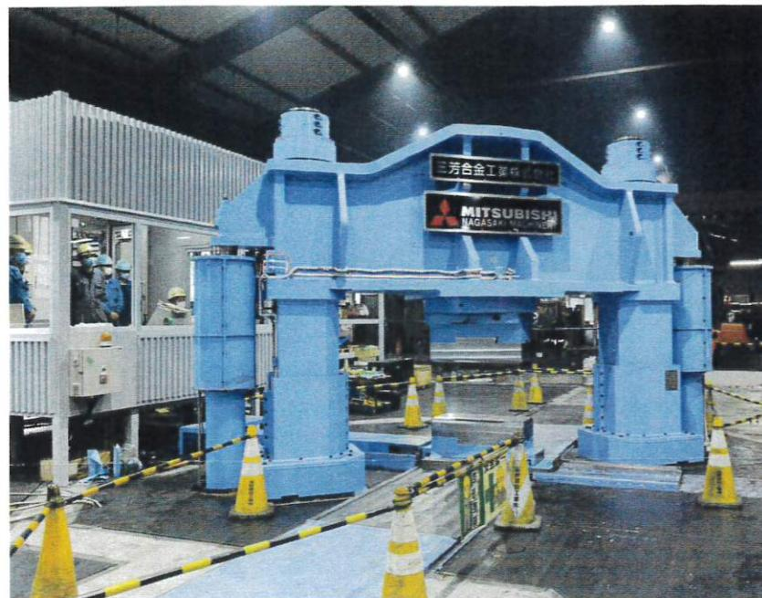
新たに導入した2柱式プルダウン型1500Tプレス
